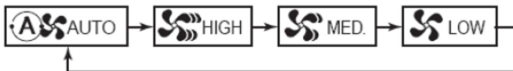
A gomb megnyomásával a képen látható sorrendben változnak az üzemmódok. Amikor a légsebesség „AUTO”-ra van állítva, akkor a ventilátor sebessége a szoba hőmérsékletétől függően változik. Alapesetben a központi vezérlőegységen ez a funkció kerül beállításra. Javasoljuk ezt a funkciót használni.
